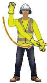
LIBERAR CARGA DE ESLINGA El brazo izquierdo se mantiene alejado del cuerpo. El brazo derecho atraviesa el izquierdo en un movimiento cortante desde arriba.
